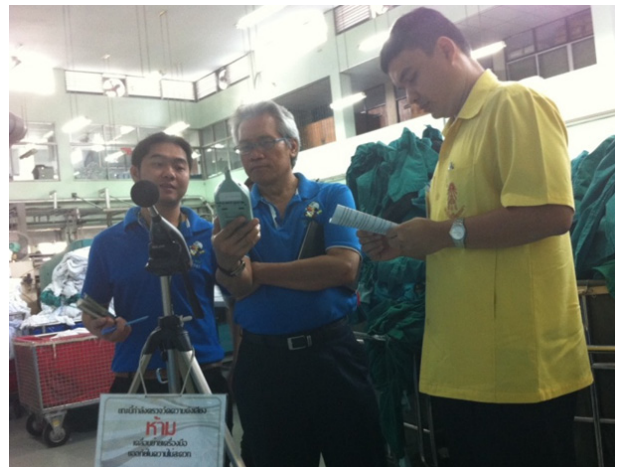
รูปที่ 3 แสดงการติดตั้งเครื่องวัดเสียง Sound Pressure Meter สำหรับแหล่งกำเนิดเสียงที่มีลักษณะความดังแบบต่อเนื่อง โดยตั้งที่ระดับความสูง 1.2 เมตร และห่างจากผนังมากกว่าหนึ่งเมตร เพื่อป้องกันเสียงสะท้อน
